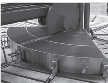
Fig. 11: Les rotors de grands diamètres sont découpés en plusieurs segments par sciage.
