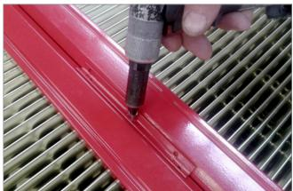
Bild 7: Rivet on the angle brackets
