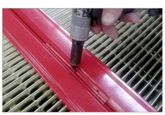
Bild 7: Rivet on the angle brackets
