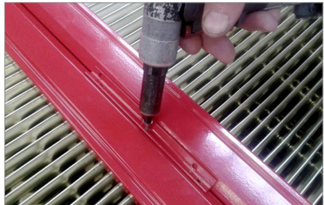
Bild 7: Rivet on the angle brackets
