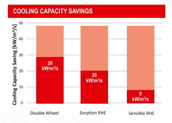
Besoin de refroidissement total requis 48 kW/m3/s Conditions air neuf et repris suivant diagramme HX
