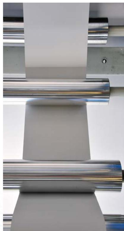
Macchina di rivestimento della lamina
